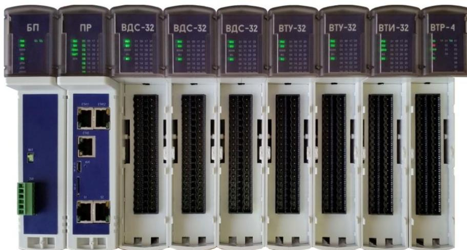
Рисунок 2 – Фотография общего вида контроллера исполнения САТЕЛЛИТ-Р
