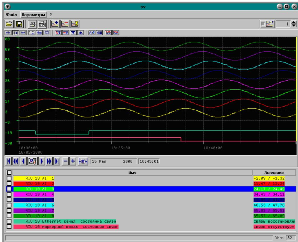
Рис. 5. Работа механизма отложенной передачи при отключениях одного из двух каналов связи. Зеленая и красная линии в нижней части графиков – состояние каналов связи. Восемь синусоидальных сигналов в верхней части – значения, приходящие от КП и имитирующие изменения реальных аналоговых сигналов («телеизмерения»).
